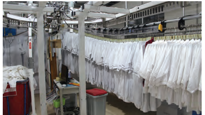
▲ IC チップ管理によるソーティングシステム
