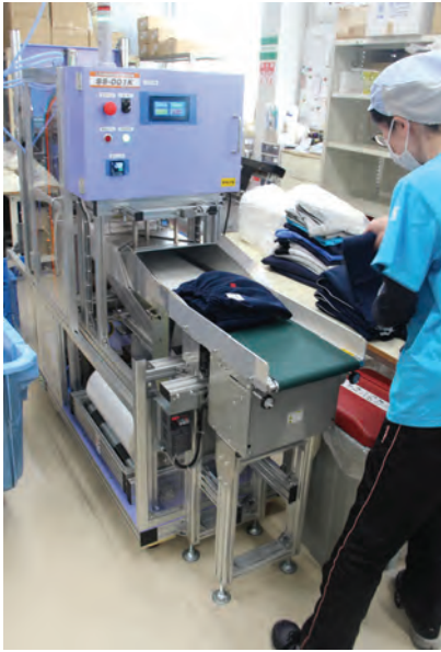
▲ユニフォームやガウンを脱気包装。自動包装機で省人化、作業時間短縮、そして誰でも安定した品質となった
