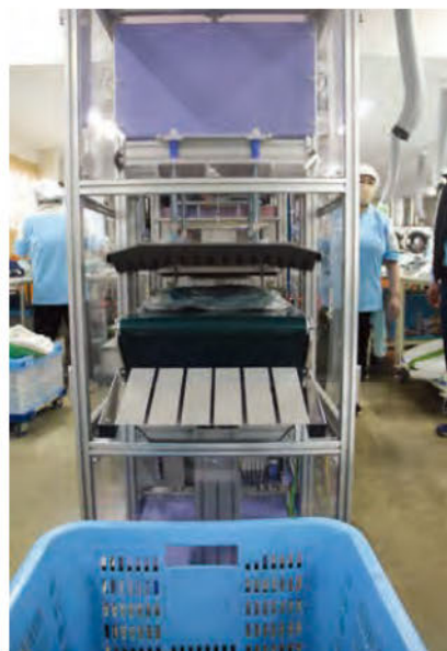
▲たたんだ私物をコンベアにセットすると、自動で幅を整えて上からプレス、脱気しながら包装、シールする
