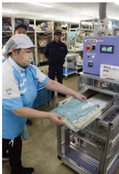
▲たたんだ私物をコンベアにセットすると、自動で幅を整えて上からプレス、脱気しながら包装、シールする
