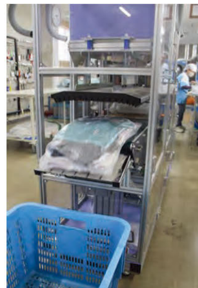
▲たたんだ私物をコンベアにセットすると、自動で幅を整えて上からプレス、脱気しながら包装、シールする
