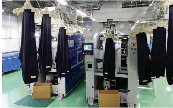
◀左はガス式のユラフォームフィニッシャー。次に、右のユラフォームフォルダーに入り、コンベアで下の全自動包装機へ
