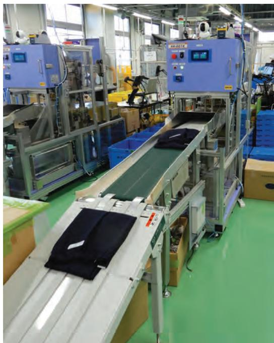
◀昨年6月、新工場開設に合わせて導入した三方全自動包装機「SS-001K」。省人化を目的に採用した同機2台により、1日約1万点のユニフォーム包装を2人でこなせるようになった。
