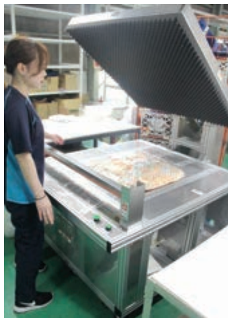
◀補助金を活用して導入したふとん・毛布圧縮機能付きシール機「SF-95A」。既存の真空包装機に比べ作業時間は約3分の1となり、これまでのボトルネックを解消した。
