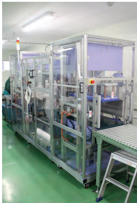
◀昨年7月に導入したタオル専用全自動包装機「SS-032」。タオル自動機も3台導入し、投入からたたみ、包装を自動化した
