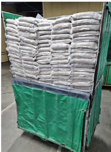
◀脱気包装により台車への積込量が増加。物流の効率化につながった
