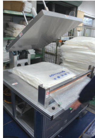
▲スタートボタンを押すとプレス板が下降して脱気を行う
