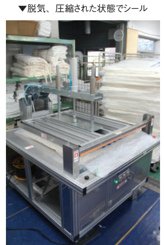
▼脱気、圧縮された状態でシール
