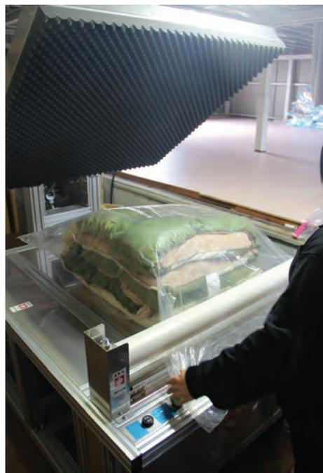
◀ 助成金を活用して導入したふとん・毛布圧縮機付きシール機「SF-95A」。機械化により生産性を高め、暑い作業場での労働負担を解消した
