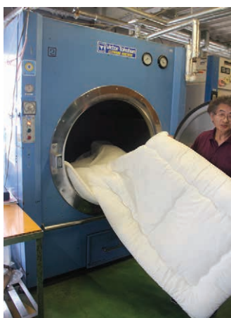
▲◀ 洗浄後は布団乾燥室と大型乾燥機のダブル乾燥により、ふっくらと仕上げる ▼防ダニ抗菌加工済証
