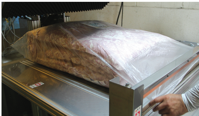
▲布団を均一にプレスしながら脱気してシールカットすると、かさばる布団が右のような状態に仕上がる
