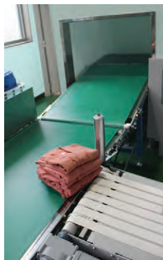
▲▶ユニフォームはたたみも自動化したほかコンベアシステムも導入
