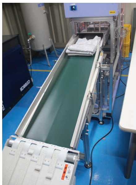
▲今年8月に増設した自動ライン。2台目となるトンネルフィニッシャーから出た品物は、ユニフォームフォルダーでたたまれ、コンベアでそのまま全自動包装機に投入される
