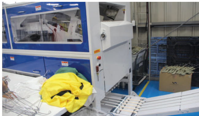
▲今年8月に増設した自動ライン。2台目となるトンネルフィニッシャーから出た品物は、ユニフォームフォルダーでたたまれ、コンベアでそのまま全自動包装機に投入される
