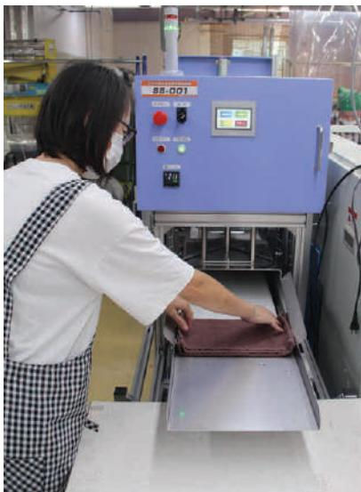
▲フェイスタオルの個包装。投入コンベアにタオルをセットすると、自動でフィルムに入り、上からタオルをプレスして中の空気を抜き(下)、シール・カットされる
